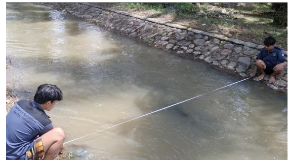
Gambar 4. Pengukuran lebar saluran
