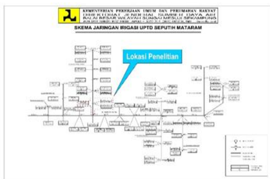
Gambar 6. Skema jaringan irigasi UPTD Seputih Mataram
