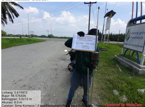
Gambar 2. Pengujian tanah dasar menggunakan alat Dynamic Cone Penetrometer (DCP) pada STA 0+500
