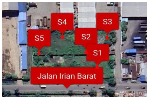
Gambar 1. Sketsa situasi letak titik pengujian sondering test
