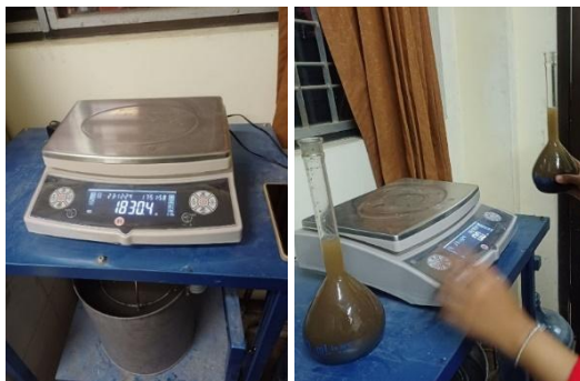
Gambar 5. Proses Pengujian Berat Jenis Sumber: Hasil Pengujian (2024)
