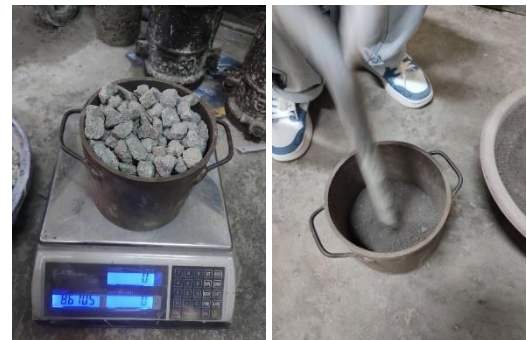
Gambar 6. Proses pengujian berat volume
