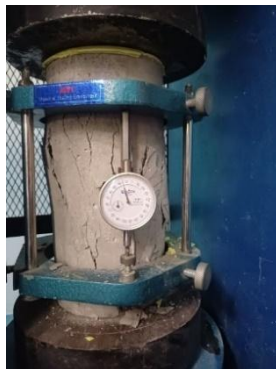
Gambar 14. Proses pengujian modulus elastisitas
