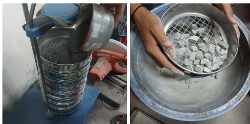
Gambar 7. Proses pengujian analisa ayakan
