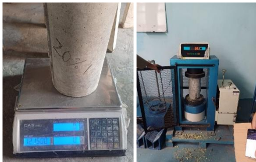
Gambar 15 Proses pengujian kuat tekan
