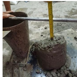
Gambar 9. Hasil pengujian slump test
