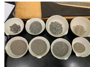
Gambar 3. Hasil pengujian analisa saringan agregat halus
