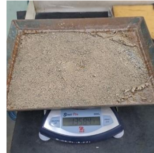
Gambar 5. Hasil pengujian berat jenis dan penyerapan air agregat halus
