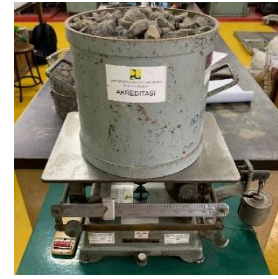
Gambar 15. Pengujian bobot isi dan rongga udara agregat kasar
