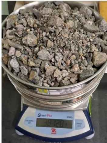
Gambar 14. Pengujian kadar lumpur agregat kasar
