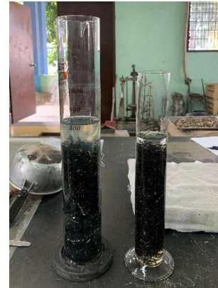
Gambar 17. Pengujian berat jenis serat bubut besi
