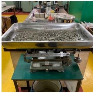
Gambar 16. Pengujian keausan agregat kasar dengan mesin Los Angeles
