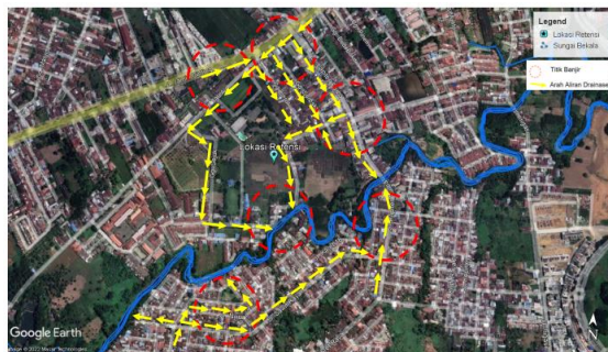
Gambar 2. Titik banjir dan arah aliran drainase sekitar rencana kolam retensi
