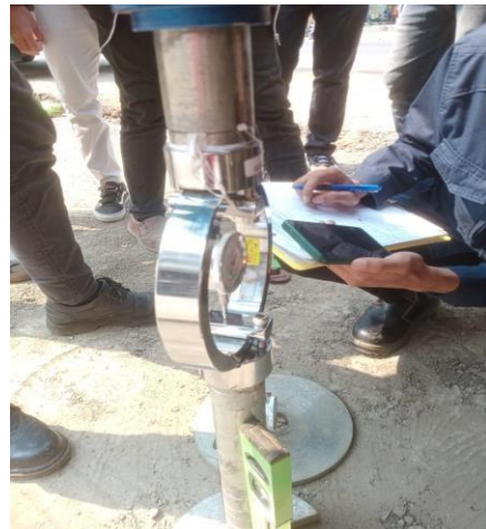
Gambar 10. Uji CBR lapangan
