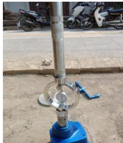
Gambar 6. Uji CBR lapangan
