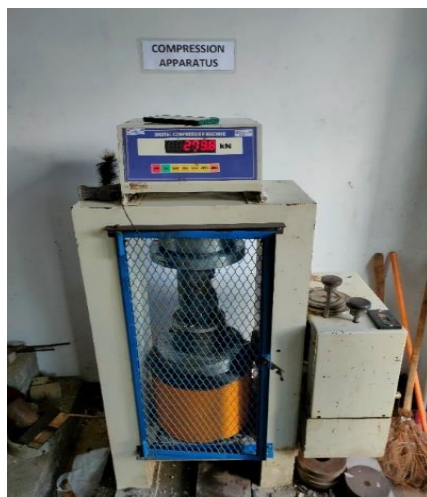
Gambar 11. Pengujian kuat tekan
