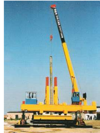
Gambar 3. Alat pemancangan hydraulic jack
