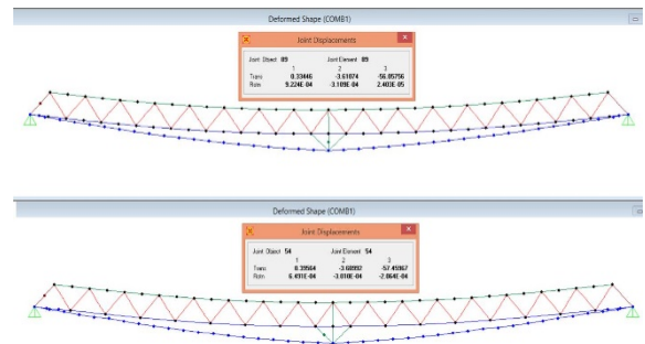
Gambar 16. Lendutan Struktur Pada Rangka Sisi Memanjang Jembatan
