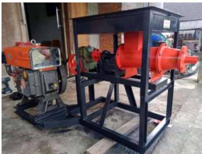
Fig. 2. Briquette extruder machine.
