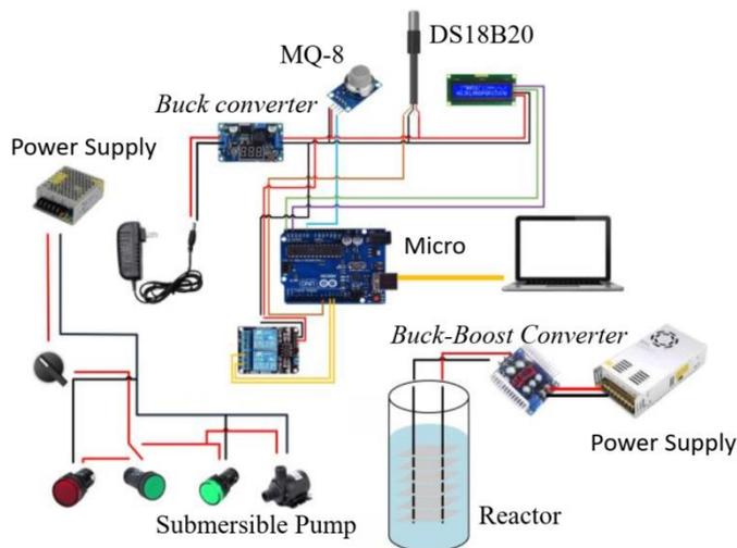
Fig. 1. Wiring diagram.
