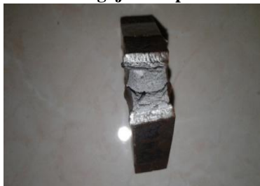
Gambar 4.3 Foto Makro Dari Spesimen Uji Impact Base Metal
