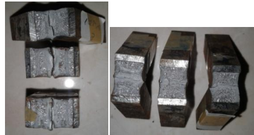
Gambar 4.5 Foto Makro Dari Spesimen Uji Impact Kelompok Arus 125 Ampere dan 150 Ampere
