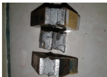
Gambar 4.4 Foto Makro Dari Spesimen Uji Impact Kelompok Arus 100 Ampere
