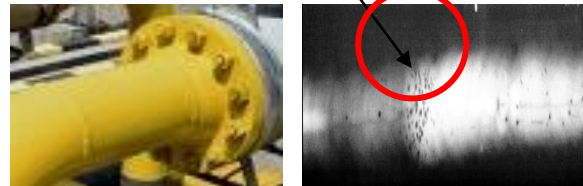
Gambar 4.1 Film Untuk Posisi 0-15 , Terdapat Cacat Las Yaitu Distributed Porosity
