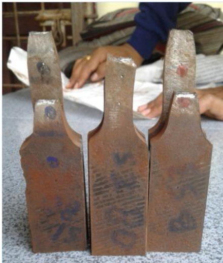
Gambar 3.2 Hasil pengujian tarik pada specimen dengan arus 80 Ampere
