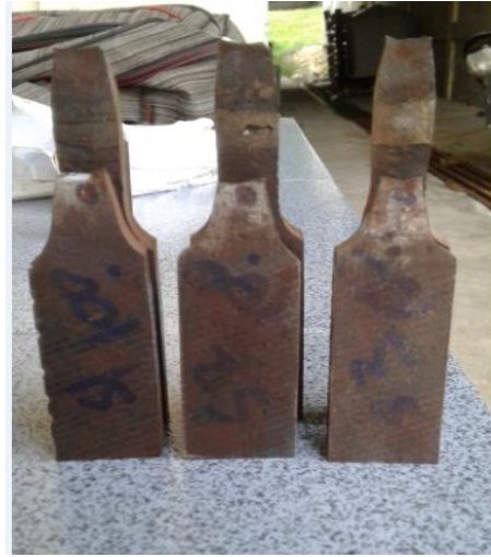
Gambar 3.4 Hasil pengujian tarik pada specimen dengan arus 100 Ampere
