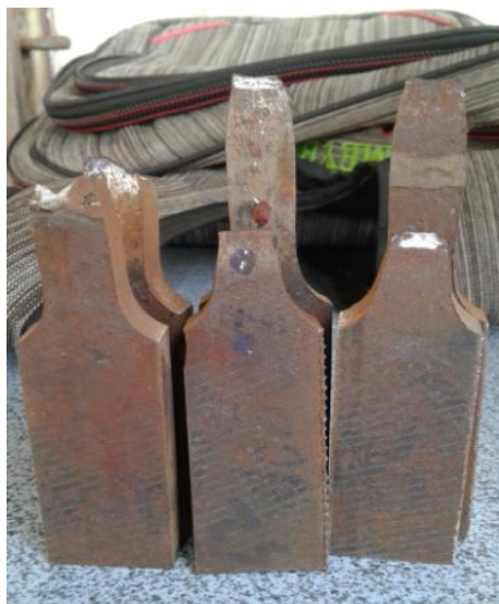
Gambar 3.3 Hasil pengujian tarik pada specimen dengan arus 90 Ampere
