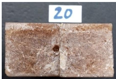
Gambar 4.5 Perpatahan Komposit Epoksi Serat Sabut Kelapa 20 menit
