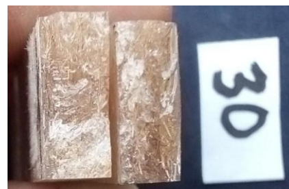
Gambar 4.9 Perpatahan Komposit Epoksi Serat Sabut Kelapa 30 menit
