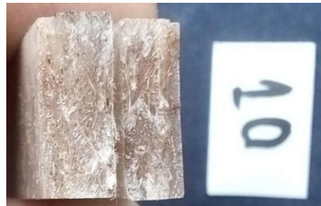
Gambar 4.7 Perpatahan Komposit Epoksi Serat Sabut Kelapa 10 menit
