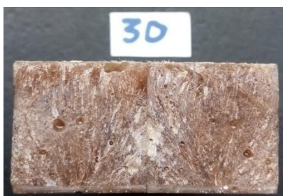
Gambar 4.6 Perpatahan Komposit Epoksi Serat Sabut Kelapa 30 menit
