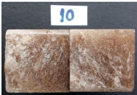
Gambar 4.4 Perpatahan Komposit Epoksi Serat Sabut Kelapa 10 menit
