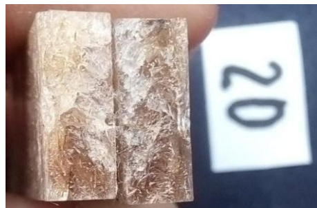
Gambar 4.8 Perpatahan Komposit Epoksi Serat Sabut Kelapa 20 menit
