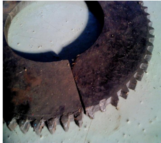
Gambar 5. Plate Clutch yang mengalami kerusakan
