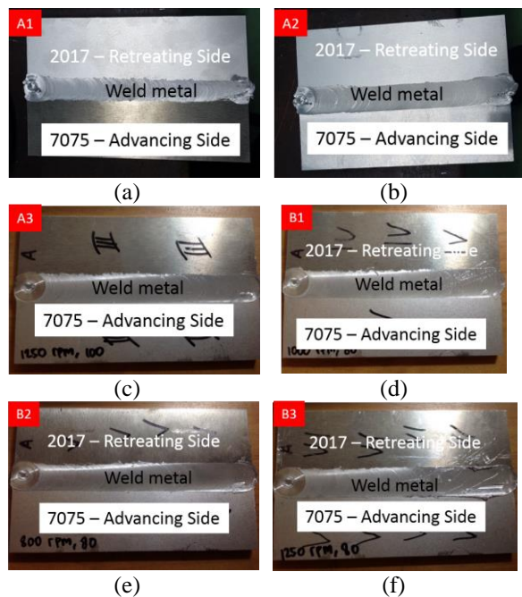
Gambar 5 Hasil Lasan Plat Spesimen: (a) A1 1000 rpm dan 100 mm/menit, (b)A2 800 rpm dan 100 mm/menit, (c) A3 1250 rpm dan 100 mm/menit, (d)B1 1000 rpm dan 80 mm/menit, (e) B2 800 rpm dan 80 mm/menit, (f) B3 1250 rpm dan 80 mm/menit.
