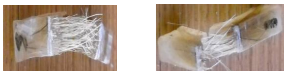
Gambar 8. Patahan Spesimen Uji impact serat nanas Fraksi Volume 50 %
