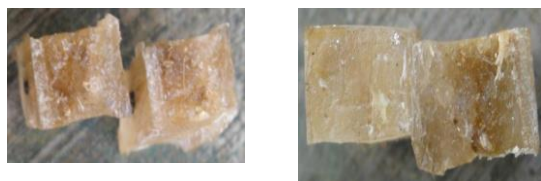
Gambar 7. Patahan Spesimen Uji impact serat nanas Fraksi Volume 30%
