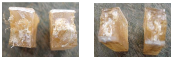
Gambar 6. Patahan Spesimen Uji impact serat nanas Fraksi Volume 10 %.
