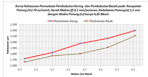
Gambar 12. Kurva Perbandingan kekasaran permukaan pembubutan kering dan pembubutan Basah pada kecepatan potong ( V_c ) 70 m/mnt
