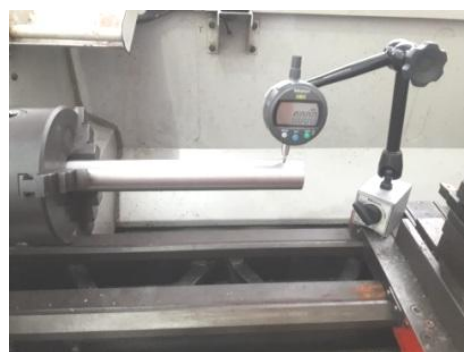
Gambar 9. Proses set-up benda kerja.
