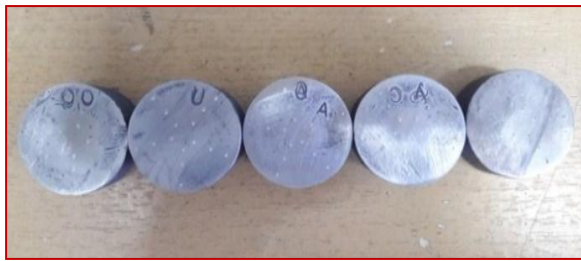
Gambar 6. Spesimen Hasil Pengujian Kekerasan Rockwell
