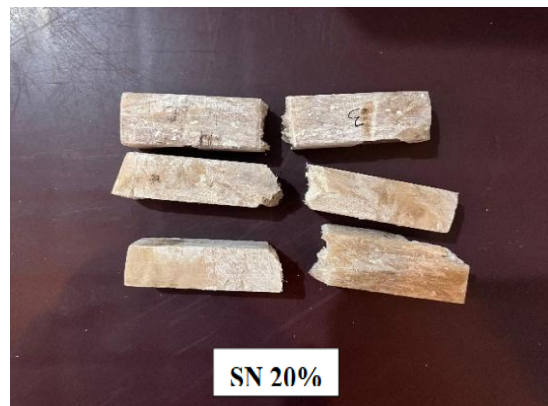
Gambar 3 (a) Sampel Pengujian Komposit Serat Daun Nanas dengan Fraksi Volume 20%
