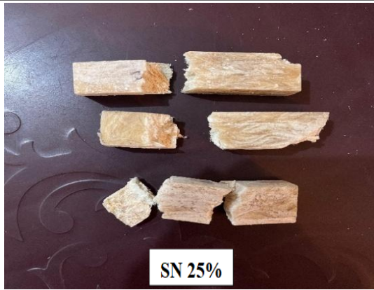
Gambar 3(b) Sampel Pengujian Komposit Serat Daun Nanas dengan Fraksi Volume 25%
