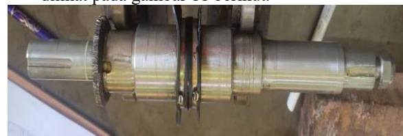
Gambar 11 Kerusakan pada Shaft
