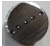
Gambar 3.1 Titik penekanan uji kekerasan Rockwell C
