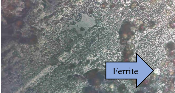
Gambar 3.4 Struktur Mikro Temperatur 825°C
