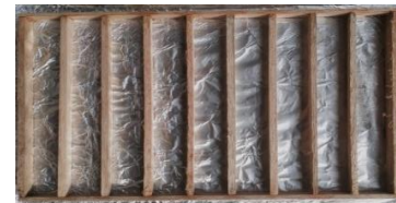
Gambar 2 Melapisi cetakan dengan aluminium foil
