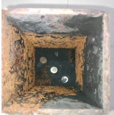
Gambar 1 Posisi letak spesimen dalam kotak carburizing
