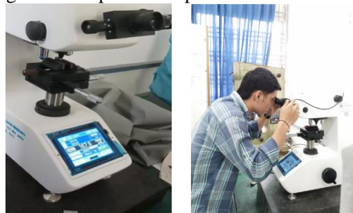
Gambar 7 Proses uji kekerasan
