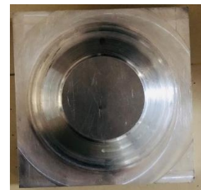
Gambar 5 hasil dies cetakan piring
