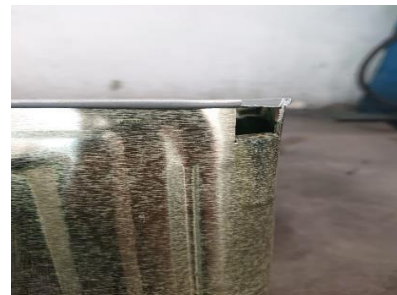
Gambar 2. Cacat Pada Bottom Seaming
