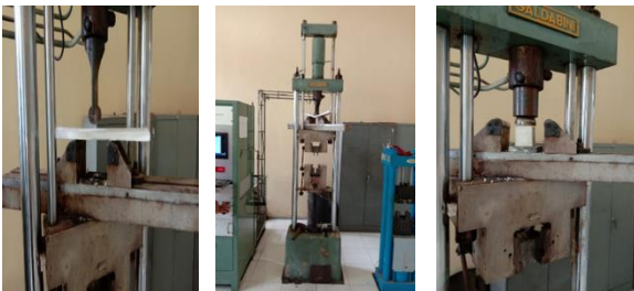
Gambar 4.3 Pengujian Uji Lentur Dan Uji Tekan
