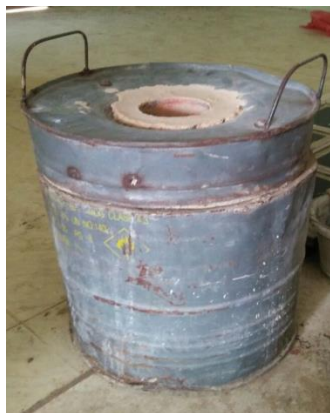
Gambar 3.1 Alat Muffle Furnace untuk peleburan kuningan 70-30% ( yellow brass ) dengan kapasitas 12 kg/peleburan
