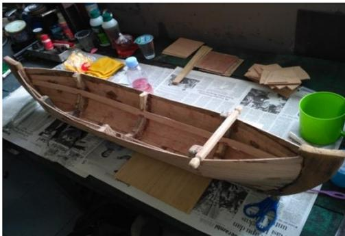
Gambar 1 Gambar Kontruksi Prototipe Perahu Nelayan
