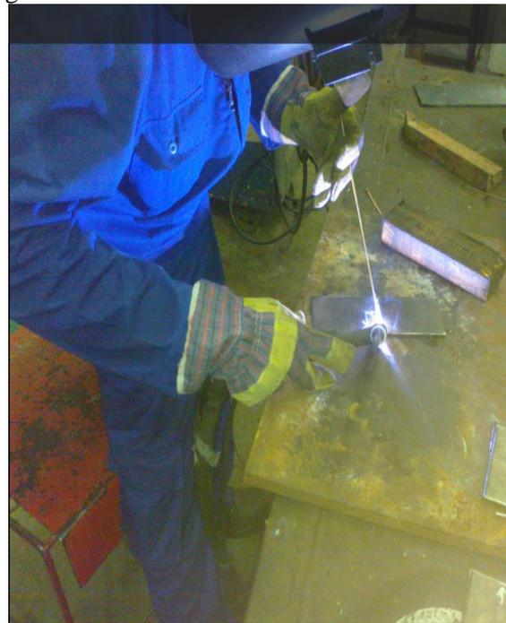
Gambar 2.6 Proses pengelasan
