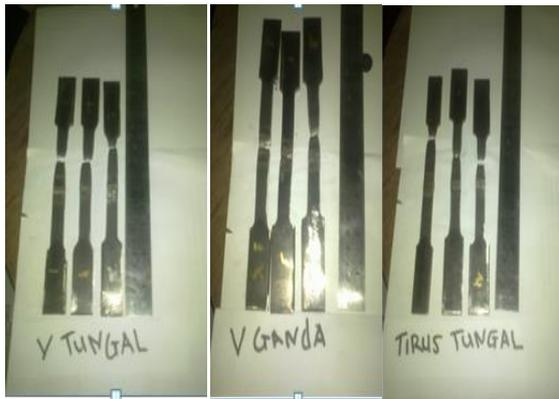
Gambar 3.2 Spesimen setelah di uji tarik
