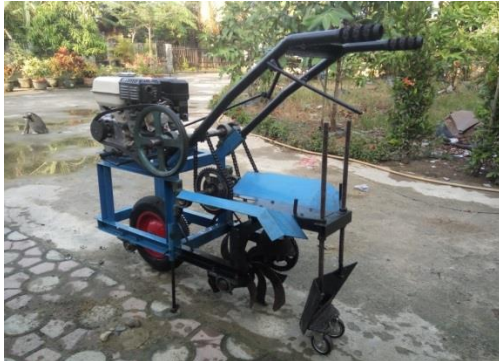
Gambar 4.1 Hasil Alat Pembuat Alur Bedengan Tanaman.
