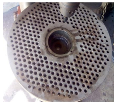
Gambar 4 Proses Modifikasi Lubang Laluan dengan menggunakan Countersink .
