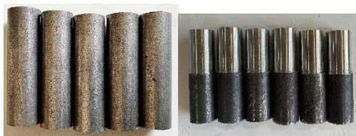
Gambar 4. 1 Spesimen sebelum pembubutan dan Spesimen setelah pembubutan
