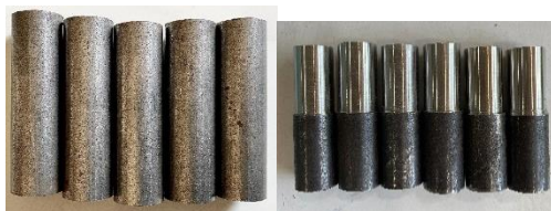
Gambar 4. 1 Spesimen sebelum pembubutan dan Spesimen setelah pembubutan
