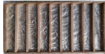
Gambar 2 Melapisi cetakan dengan *aluminium foil*
