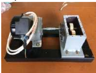
Gambar 10 hasil alat simuator gearbox untuk pengujian kinerja minyak pelumas
