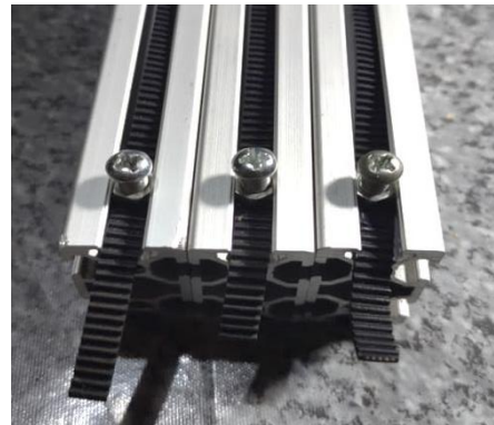
Gambar 12. Pemasangan Timing Belt Perakitan komponen penggerak
