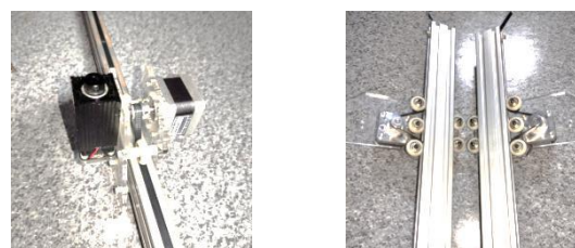
Gambar 14. Pemasangan Komponen Penggerak Pada Kerangka
