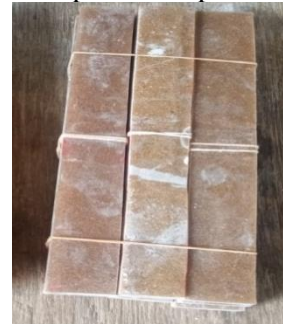
Gambar 2 Spesimen uji bending
