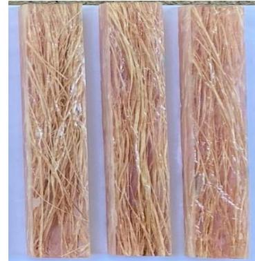
Gambar 2 Spesimen uji bending
