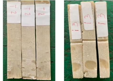
Gambar 7 Spesimen uji Tarik dan Impak
