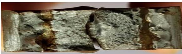
Gambar 5 Perpatahan pengelasan kampuh double tirus
