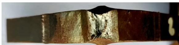
Gambar 4 Perpatahan pengelasan kampuh v
