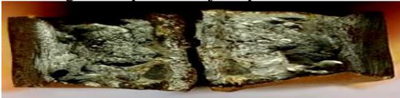
Gambar 3 Perpatahan pengelasan kampuh tirus
