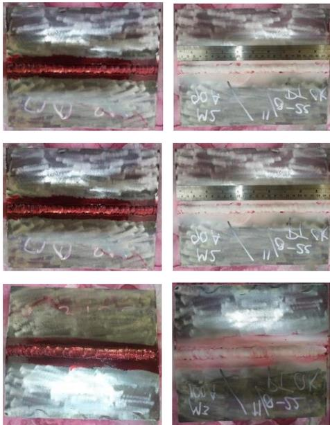
Gambar 3 Hasil Pengujian Penetran Pada Hasil Pengelasan
