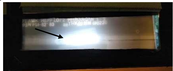
Gambar 4 Hasil Film RT Joint 83 dengan Cacat Las Lack of Root Penetration
