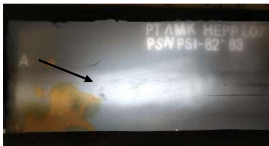
Gambar 3 Hasil Film RT Joint 82 dengan cacat las Lack of Root Penetration
