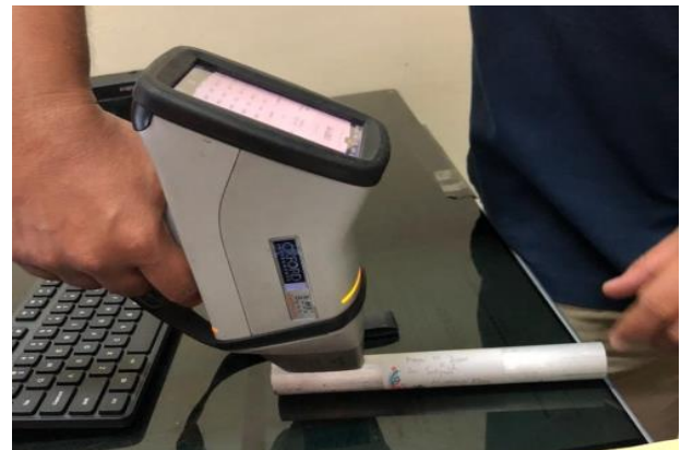
Gambar 2 Alat Pengujian komposisi kimia
