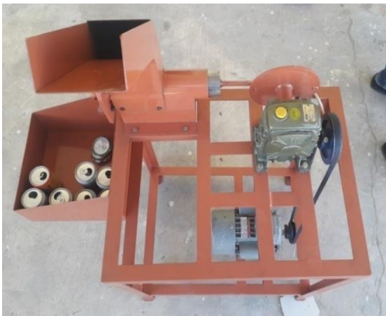
Gambar 2 Mesin Pengepres Kaleng Minuman Bekas Menggunakan Mekanisme Torak
